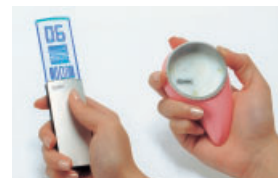
(右) パームリモコン： 回す操作とパーソナル性の高い デザイン (左) クリスタルキーリモコン： なぞる操作と光るデザイン
