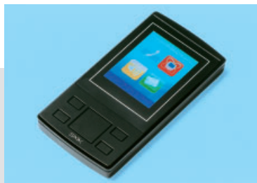
モバイル仕様 フォースフィードバック (FFB)タッチパネル
