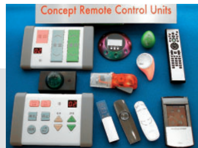
(右) パームリモコン： 回す操作とパーソナル性の高い デザイン (左) クリスタルキーリモコン： なぞる操作と光るデザイン
